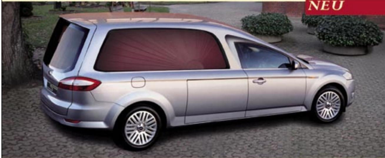
Welsch Karosserie auf Mondeo Fahrgestell, Sargraumbreite 1420 mm (lichtes Maß in 400mm Höhe auf dem doppelten Boden), Edelstahlschiebeboxe kombinierte 1- oder 2-Sargausführung
