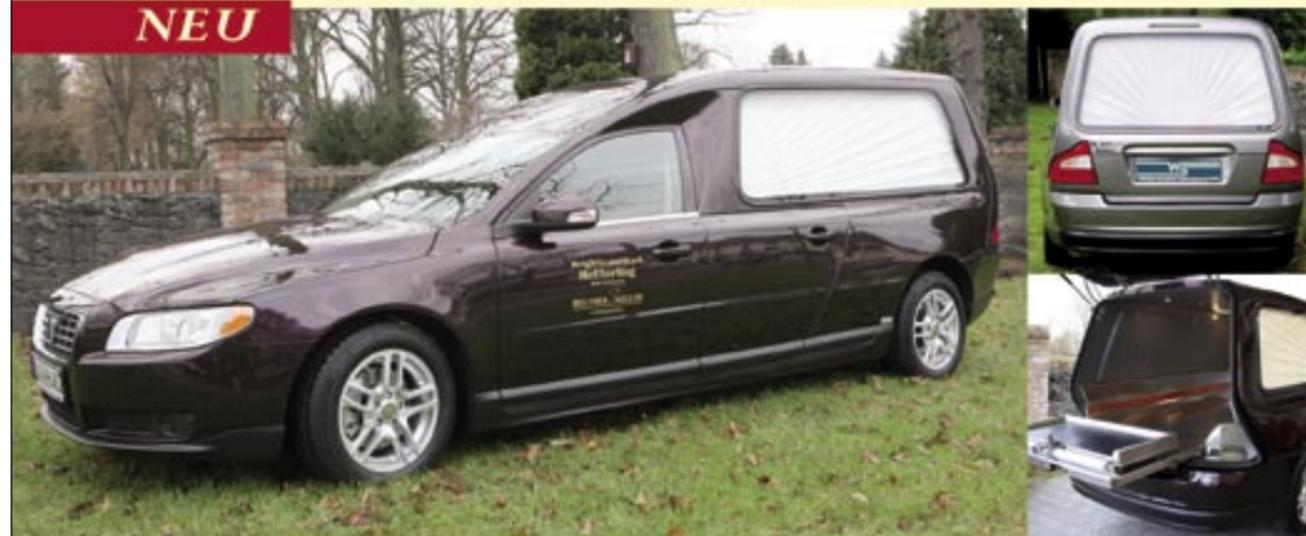
Welsch Karosserie auf Basis VOLVO S80, Sargraumbreite 1400 mm (lichtes Maß in 400mm Höhe auf dem doppelten Boden), Edelstahlschiebebühne kombinierte 1- oder 2 Sargausführung.
