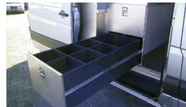
Sonderanfertigung Schubladensystem für Urnen beim 4-Sarg Transporter MB Sprinter
