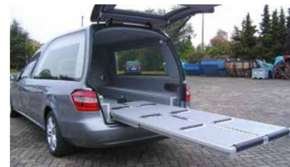
MB E-Klasse für dänischen Markt mit 1,70 Meter ausziehbarer Schiebebühne
