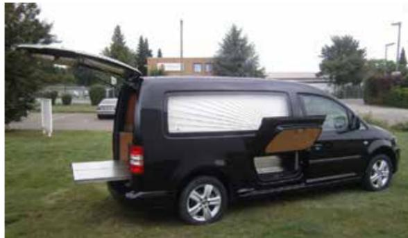
VW Caddy Maxi mit langen Seitenscheiben, seitlicher Stauraumklappe und Hubschiebebühne
