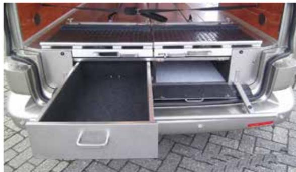
VW-T5-Ausbau mit zwei weit ausziehbaren Schiebepöhlen sowie Schubkasten links, rechts Einschubfach für Ferno-Trage
